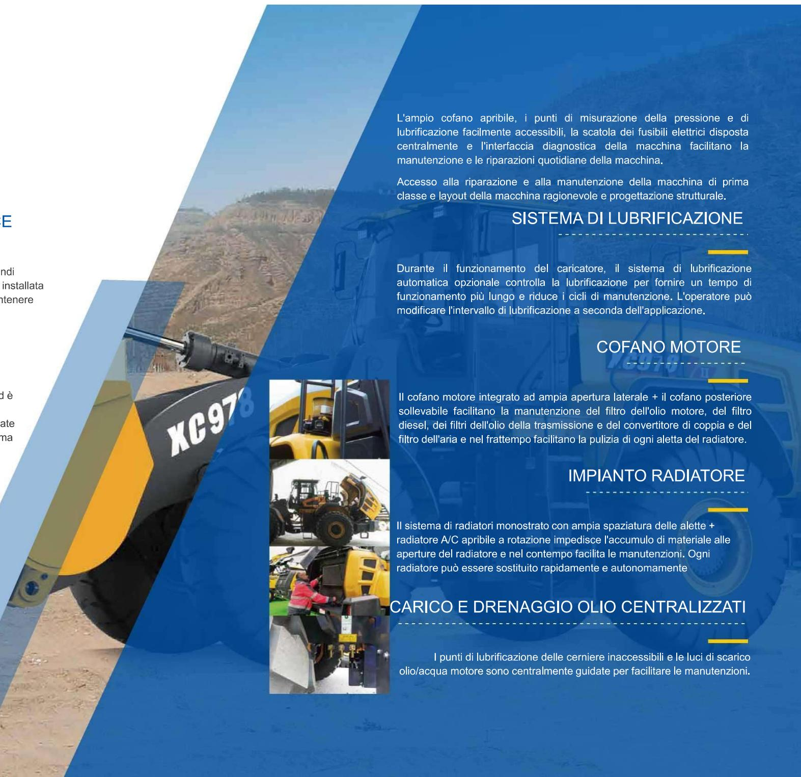
L'ampio cofano apribile, i punti di misurazione della pressione e di lubrificazione facilmente accessibili, la scatola dei fusibili elettrici disposta centralmente e l'interfaccia diagnostica della macchina facilitano la manutenzione e le riparazioni quotidiane della macchina.
