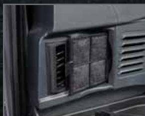
Filtro del climatizzatore per la circolazione dell'aria interna
