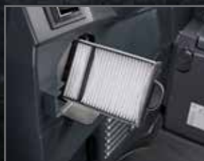
Filtro del climatizzatore per l'aspirazione dell'aria esterna
