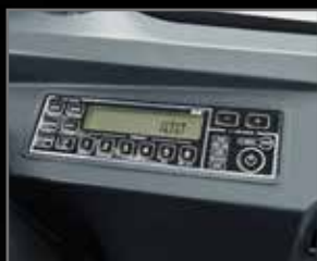
Radio DAB+ (FM/AM e AUX e USB e Bluetooth® e vivavoce per cellulare)
