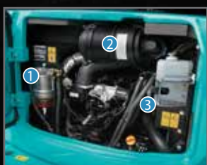
① Prefiltro del carburante con separatore d'acqua incorporato
