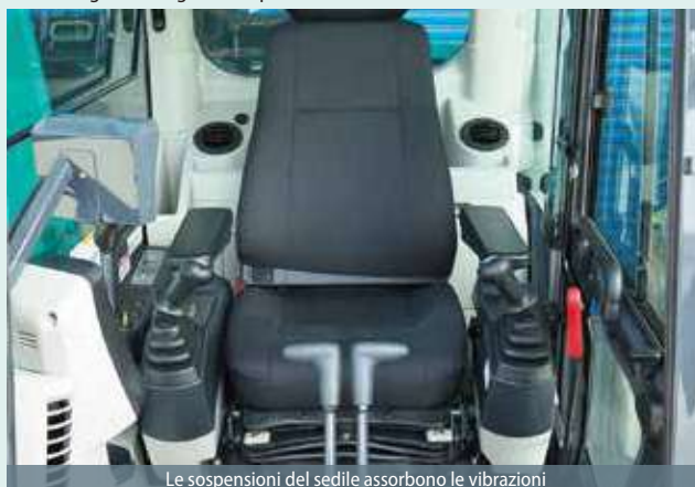
Le sospensioni del sedile assorbono le vibrazioni
